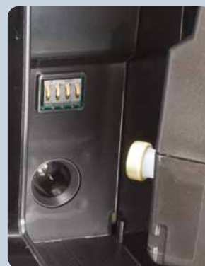
Keine Leckagen dank Nadel-Septum-Design der Kartusche
